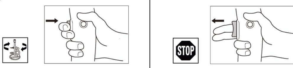
Per un funzionamento continuativo premere l'interruttore A e tenendolo premuto bloccarlo con il pulsante B; per arrestare premere l'interruttore A una volta e rilasciarlo subito.
