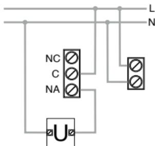
Schema di collegamento per alimentazione di pompe di circolazione, elettrovalvole, ecc. a 230V~
