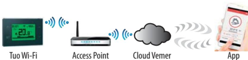
Il dispositivo si connette al Cloud Vemer per verificare se ci sono modifiche alla configurazione e alla programmazione creata utilizzando la app, e in caso affermativo, regola la temperatura secondo la nuova configurazione. Questa operazione avviene all'incirca una volta al minuto.
