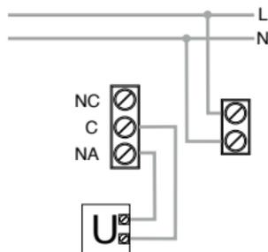
Schema di collegamento per comando caldaia, pompe di calore, ecc.
